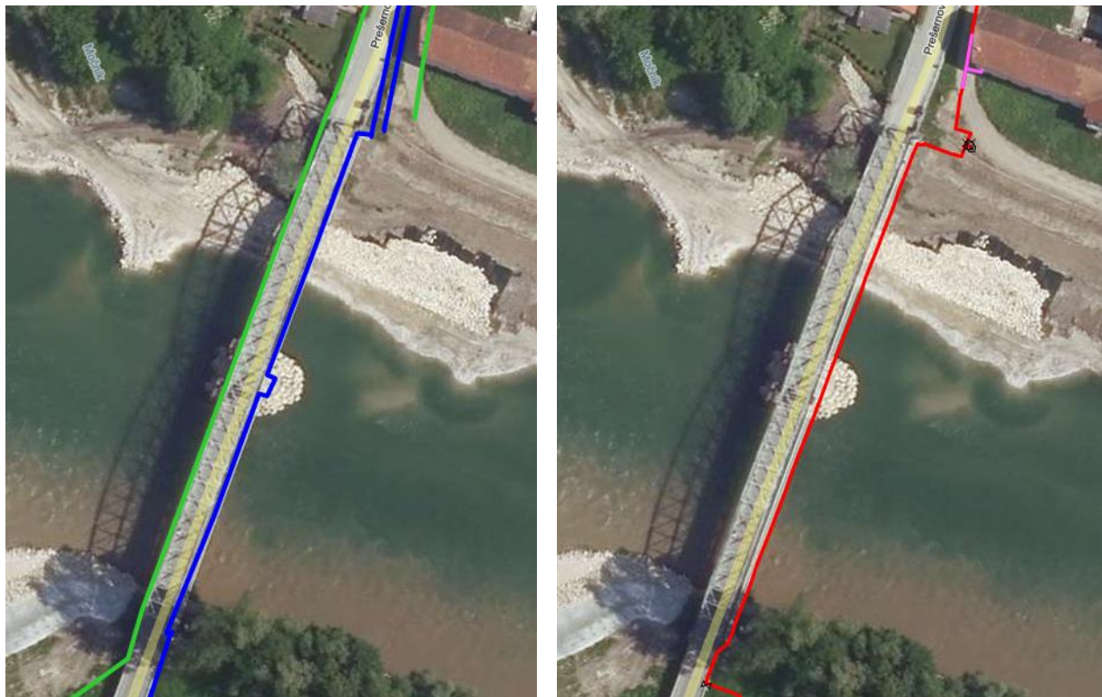
Prikaz komunalnih vodov: telekomunikacije (zelena), vodovod (modra), plin (rdeča)
