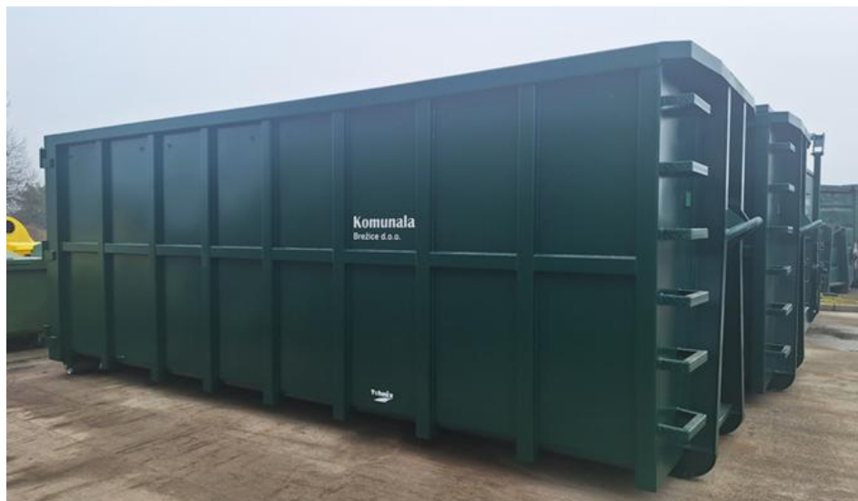
Slika 4: Prikaz kotalnega prekucnika za odlaganje in prevoz odpadkov
