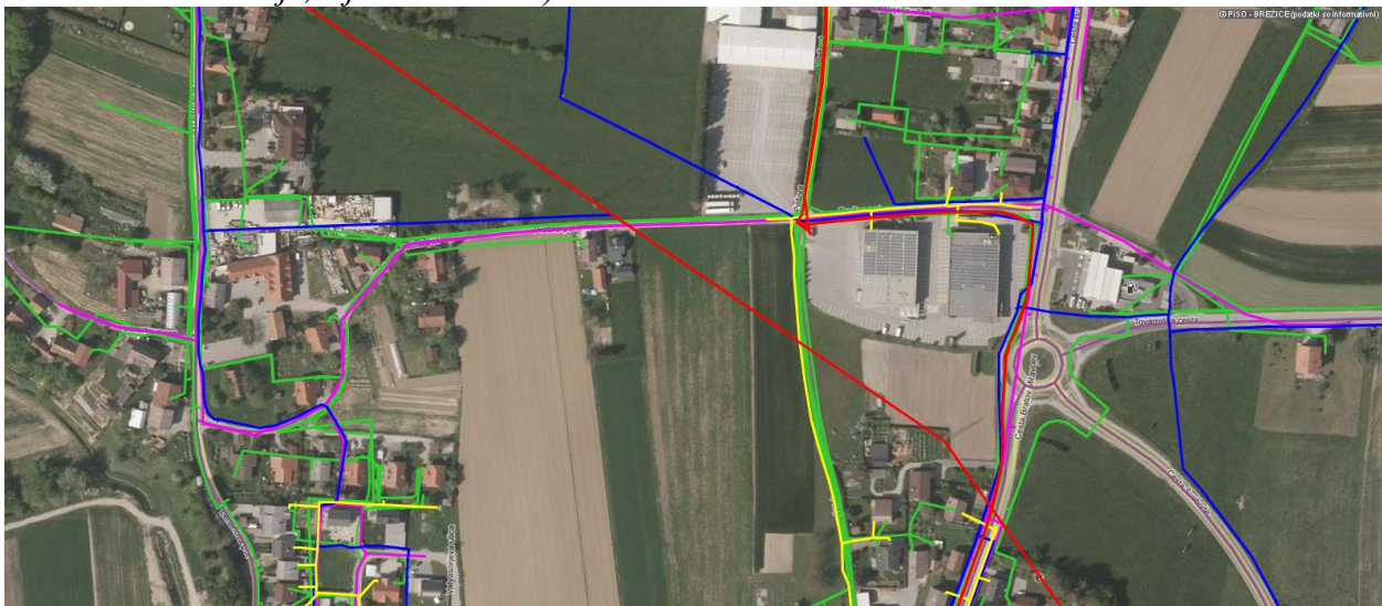
Slika 4: Prikaz obstoječe komunalne opreme in druge gospodarske javne infrastrukture na širšem območju urejanja (rdeče – elektrovod, rumeno - plinovod, modro - vodovod, roza - kanalizacija, zeleno - komunikacije, vijolično – ceste)
