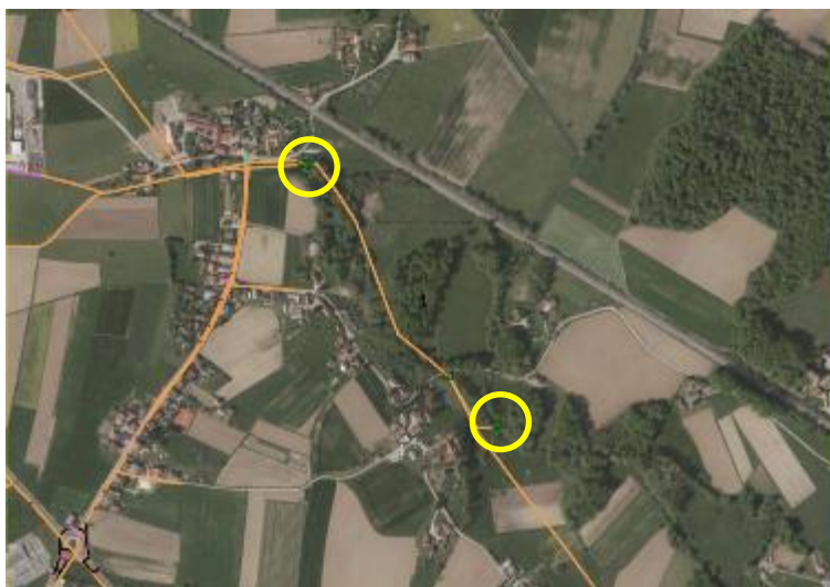
Slika 8: Razbremenilnika na kanalu Brežice – iztok v vode
