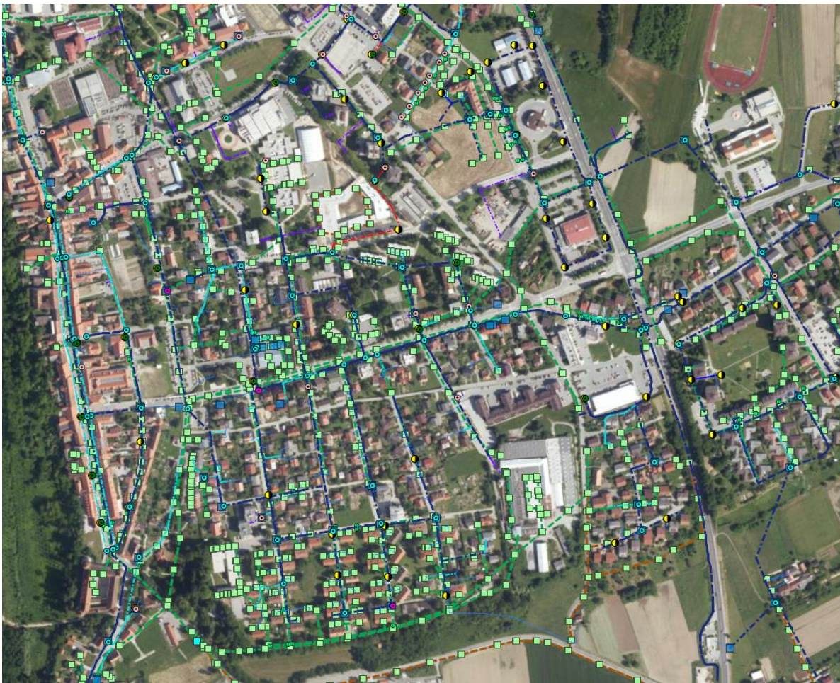
Slika 9: Kataster vodovoda in kanalizacije
