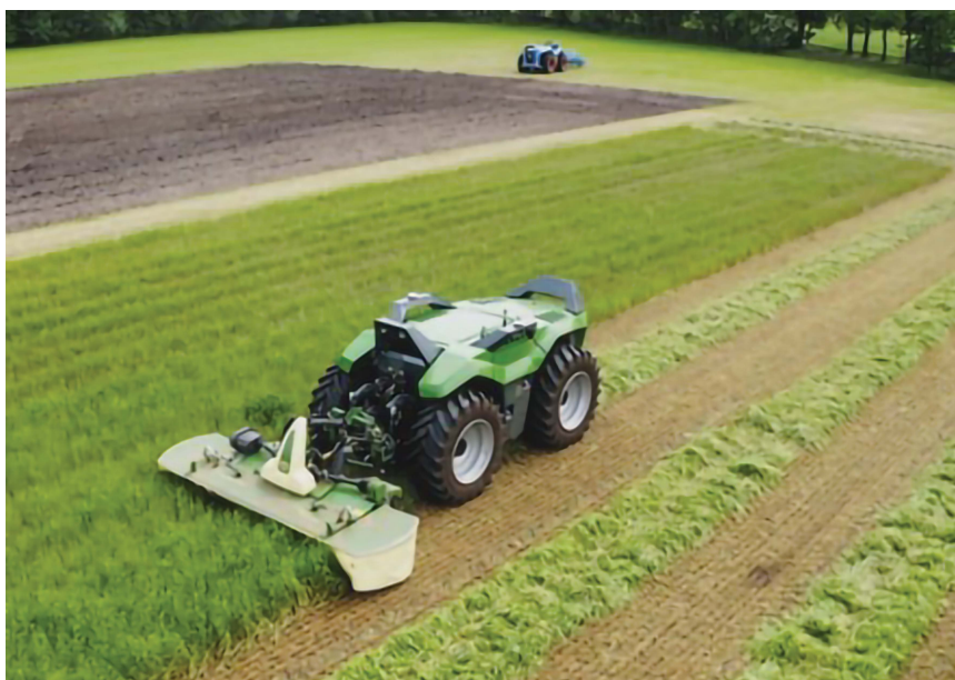
Slika 9: Avtonomna 'procesna enota', sestavljena iz pogonske enote in različnih priključkov (Vir: Krone)
