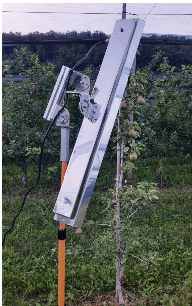
Slika 11: Osvetljevanje nasada jablan z UV-C svetlobo na kmetiji Brili na Senovem. Žarnice so nameščene na traktorskem priključku, ki ga je razvila in izdelala ekipa projektnega partnerja Fakulteta za strojništvo UM (Vir: EIP UV4plants)
