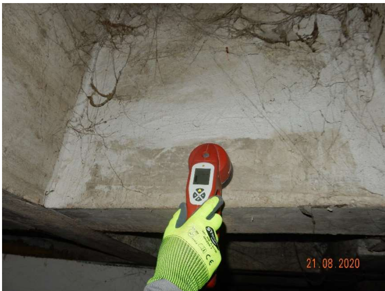
Slika 61: Meritve vgrajene armature s profometrom
