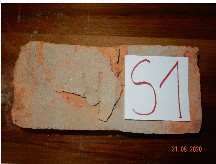
Slika 63: Vzorec zidaka na mestu S1; zaradi poškodovanosti vorec ni bil vključen v preskus tlačne trdnosti
