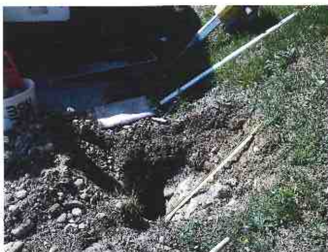
Slika 17 - 19: Lokacija izvedenega sondažnega jaška SR2 in ugotovljena sestava pri šolskem igrišču v km 0+060 (desno 1 m od roba vozišča)
