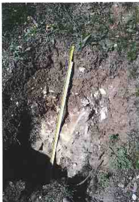
Slika 17 - 19: Lokacija izvedenega sondažnega jaška SR2 in ugotovljena sestava pri šolskem igrišču v km 0+060 (desno 1 m od roba vozišča)
