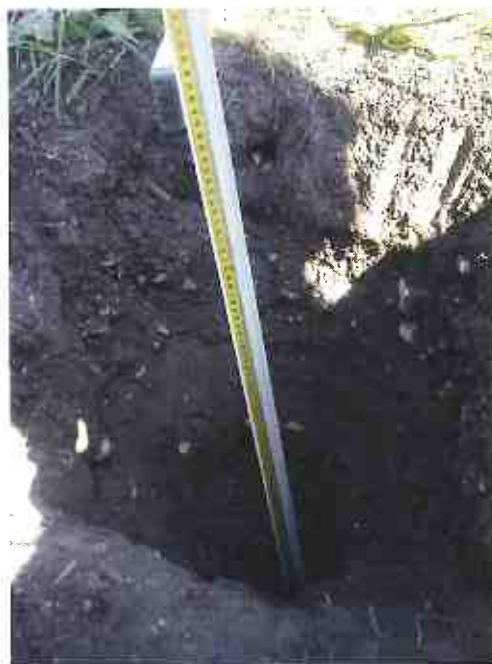
Slika 10, 11: Lokacija izvedenega sondažnega jaška SR1 in ugotovljena sestava pri avtobusnem postajališču v km 0+090
