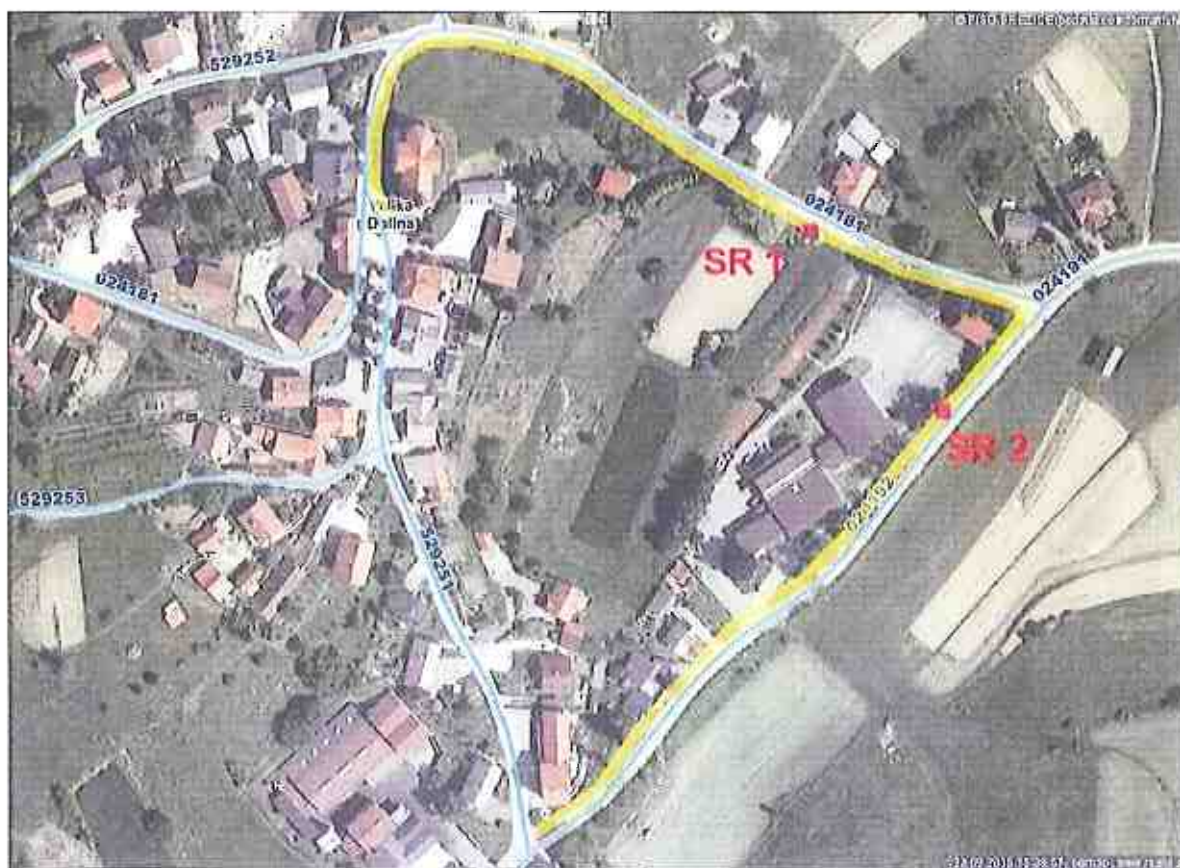
Slika 1: Lokacija izvedbe sondažnih razkopov SR 1 v nasipu pri predvideni razširitvi za AP, ter SR 2 v brežini pri širitvi za hodnik za pešce
