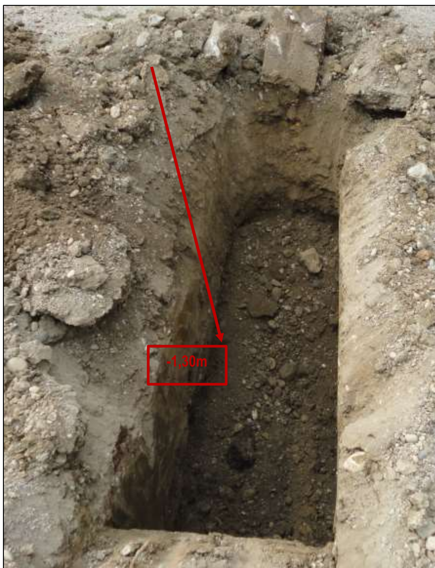
Slika 5. Sondažni razkop J2 na končni koti 1,30 metra.
