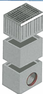
peskolov s pocinkanim vedrom in mufo, 2delen z vmesnim delom in litoželezno rešetko z regami 2*140*20, črna, raz. obr. F 900
